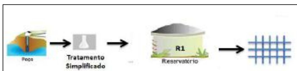
Figura 29: Sistema de captação e tratamento dos poços artesianos
